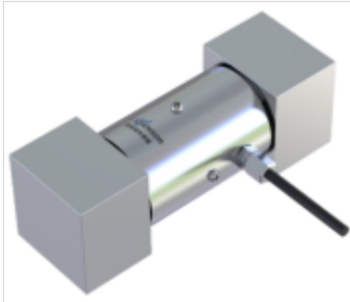
力传感器之称重传感器：称重传感器的精度等级包括传感器的非线性、蠕变、重复性、滞后、灵敏度等技术指标。在选择高等级传感器时，不应考虑电子秤的精度等级和成本。一般来说，非线性、非重复性和滞后三项指标之和的均方根值略高于标度。称重传感器实际上是一种将质量信号转化为可测量信号的电信号输出装置，首先要考虑传感器的实际工作环境，这对传感器的正确选择非常重要，它关系到传感器能否正常工作及其使用寿命，甚至关系到整个衡器的可靠性和安全性。一般来说，高温环境会导致涂层材料的熔化、焊点的开启、弹性体应力的结构变化等；粉尘和湿度对传感器短路的影响；传感器弹性体在高腐蚀环境下的损坏或短路现象；以及电磁场对传感器输出的干扰。
